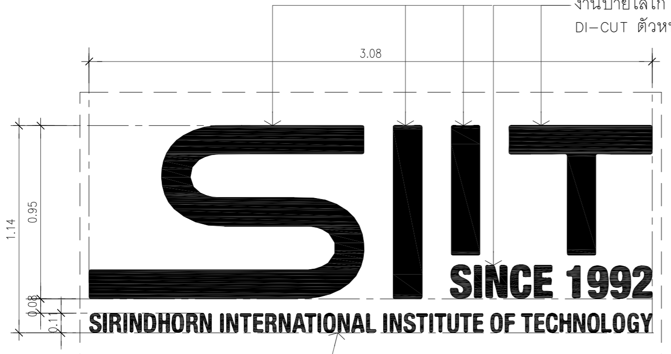
DETAIL 10 ตัวอักษร สเตนเลสยกขอบพร้อมทำสีอบ แบบขยายป้ายไฟ มาตราส่วน 1:15
